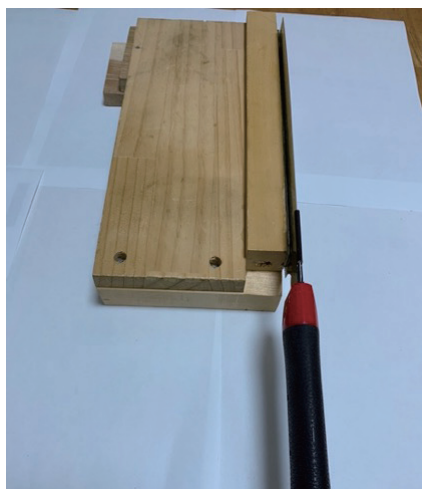
写真3 治具の磁石によって鋸が垂直になっている様子
